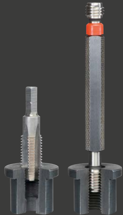
Prüfung eines mit einem STI-Gewindebohrer geschnittenen Aufnahmegewindes mittels STI-Präzisions-Gewindelehndorn - vor dem Verbau des V-COIL Gewindeeinsatzes.
