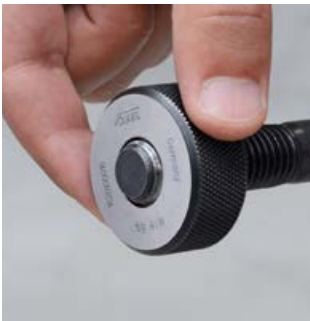
Prüfung mit Präzisions-Gewindelehrring Checking with Precision Thread Ring Gauge
