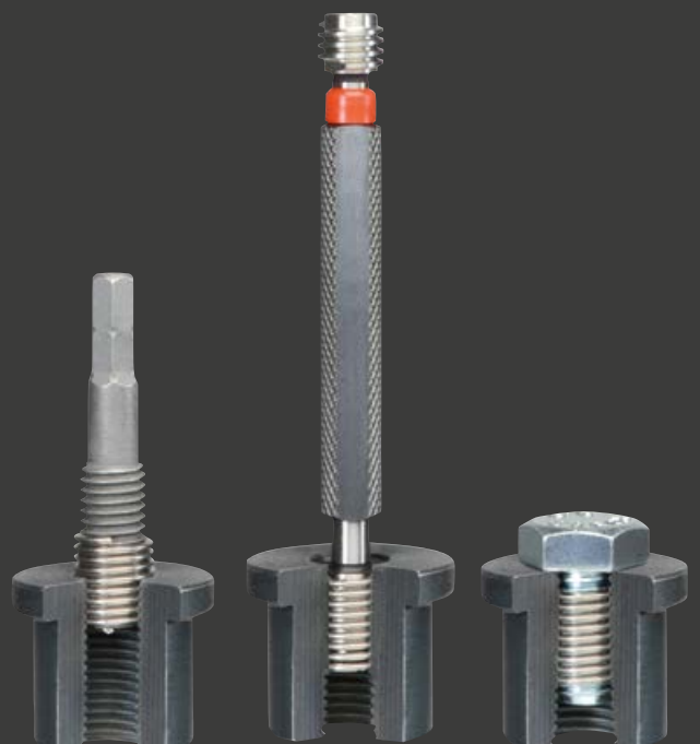
Prüfung der Maßhaltigkeit eines in das Aufnahmegewinde verbauten V-COIL Gewindeeinsatzes mit einem Präzisions-Gewindelehndorn für Standardgewinde
