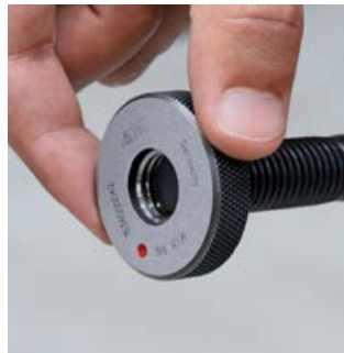
Prüfung mit Präzisions-Gewindelehrring Checking with Precision Thread Ring Gauge
