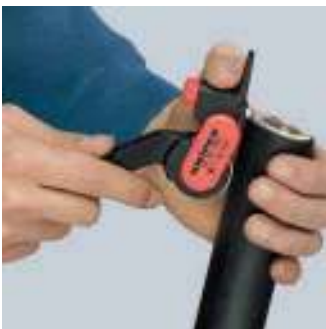
Colocar la herramienta para corte longitudinal
