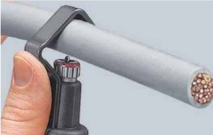
Colocar la herramienta para corte circular
