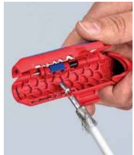
Pelar un cable coaxial
