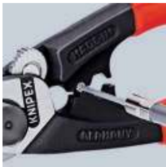
Prensar el terminal al cable de tracción
