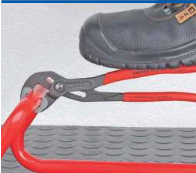
Los dientes desplazados con respecto al sentido de giro provocan un efecto de auto-retención y evitan el deslizamiento sobre la pieza.
