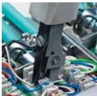
Corta y presiona en una sola operación
