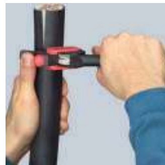
Girar la herramienta para el corte perimetral
