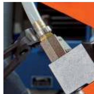
Cierre estanco de conexiones con tubos flexibles en sistemas de lubricación central
