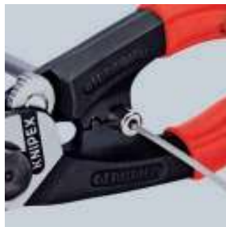
Prensar los terminales a la funda Bowden
