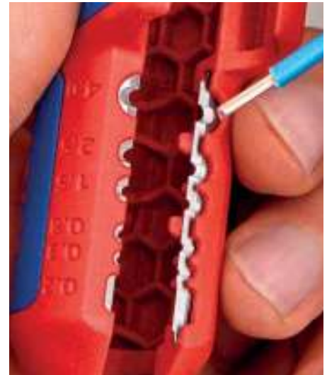
Retirar el aislamiento de conductores individuales
