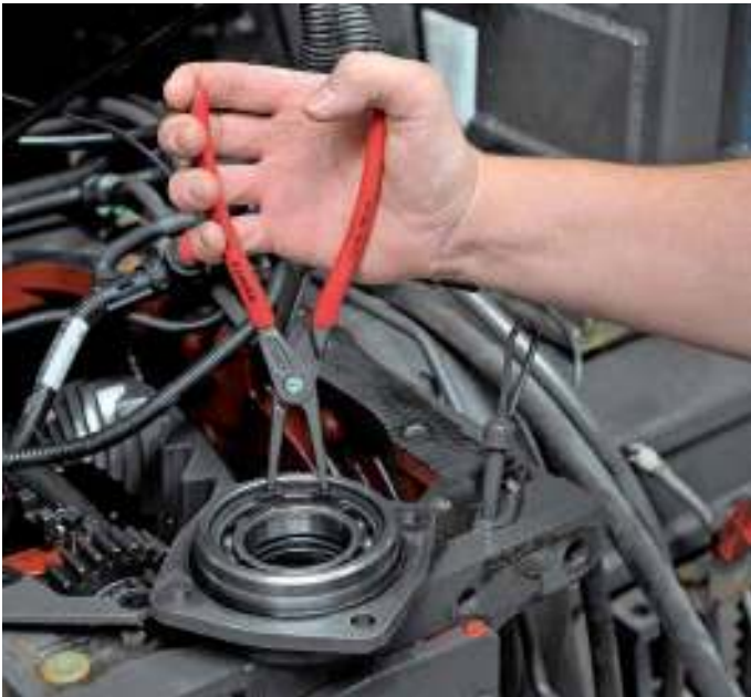
Puntas estables insertadas, fabricadas en acero para muelles de alta densidad
