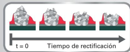
En el grano cerámico se ligan entre sí cristales de óxido de aluminio (Al<sub>2</sub>O<sub>3</sub>) mediante un proceso de sinterización. Debido a la potencia de abrasión, se quiebran estos microcristales durante el proceso de rectificación, por lo que el grano abrasivo siempre vuelve a obtener bordes cortantes afilados, nuevos.
