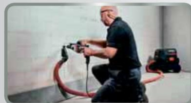
Al taladrar con golpe en mampostería, la electrónica constante VTC, el alto número de golpes y un potente arrastre proporcionan un buen progreso de perforación, incluso bajo la máxima carga.
