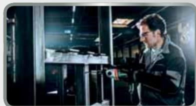
El portabrocas de sujeción rápida altamente preciso y un ajuste de las revoluciones adecuado al material garantizan incluso en metal los mejores resultados de trabajo.
