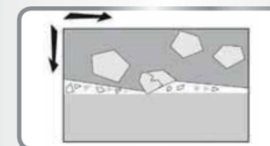
La ligadura de metal retiene cada diamante firmemente en su lugar. Durante el proceso de corte, los diamantes descubiertos en la superficie se abren paso en el material a trabajar y lo trituran, convirtiéndolo en un polvo fino.
