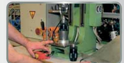
Tras el montaje se comprueba una vez más concienzudamente cada portabrocas en cuanto a su precisión de concentricidad y seguridad de funcionamiento.
