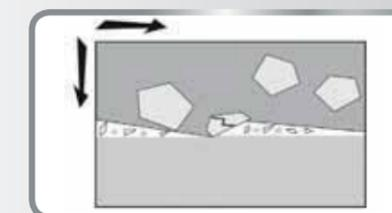
En el proceso de corte, los diamantes se astillan o se quiebran. Esto sucede con mayor rapidez cuanto más duro es el material de trabajo. Simultáneamente, el material de la masa de ligadura empieza a desgastarse debido al rectificado. Así, sucesivamente se liberan diamantes nuevos.
