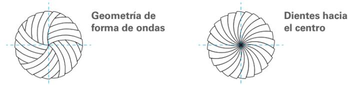
Las fresas MD con dentado frontal redondo se fabrican con una geometría de onda; el resultado es una mejor calidad de corte en el extremo de la herramienta.
