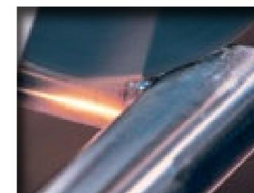
Gracias a su construcción extremadamente plana, la lijadora de soldaduras en ángulo puede trabajar también en rincones y ángulos muy cerrados. Seleccione el nivel de revoluciones 5\* y elimine sin fatigarse el cordón de soldadura en ángulo sin dañar las superficies colindantes.
