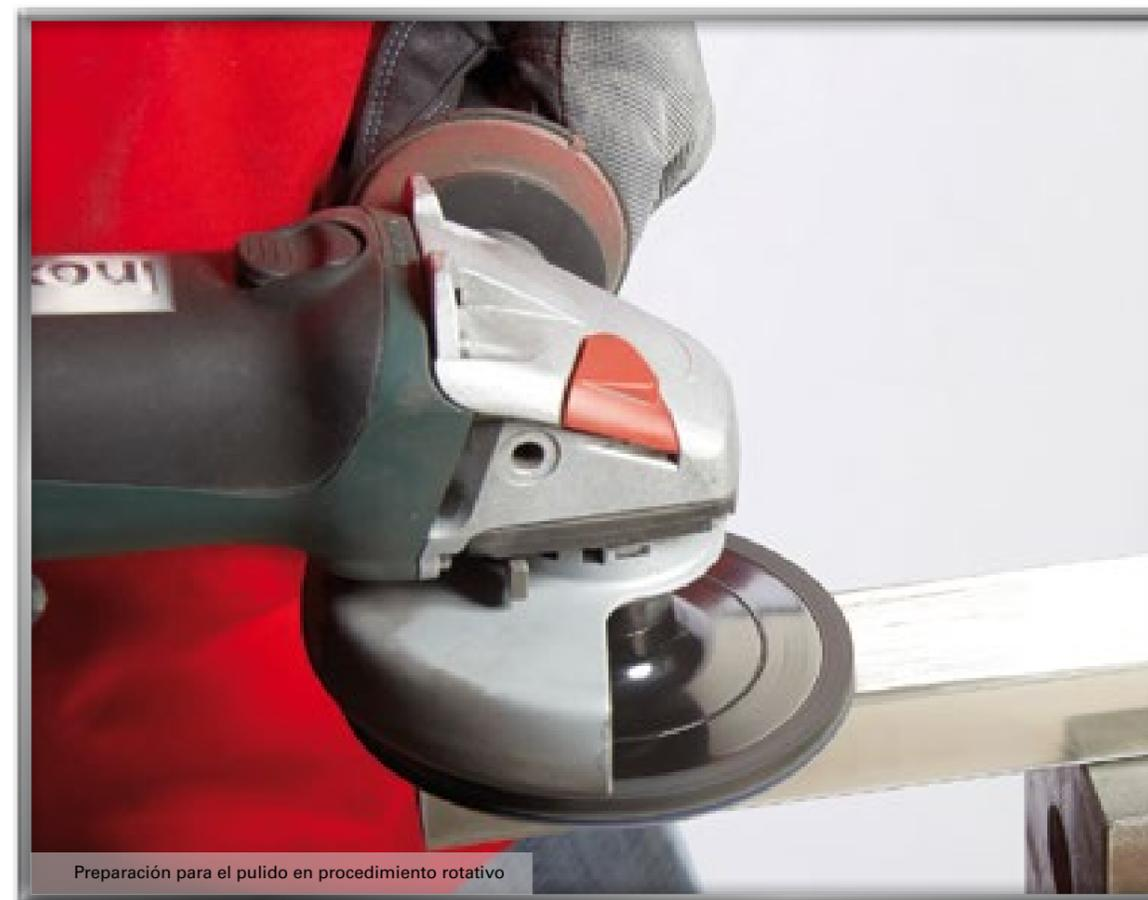
Preparación para el pulido en procedimiento rotativo
