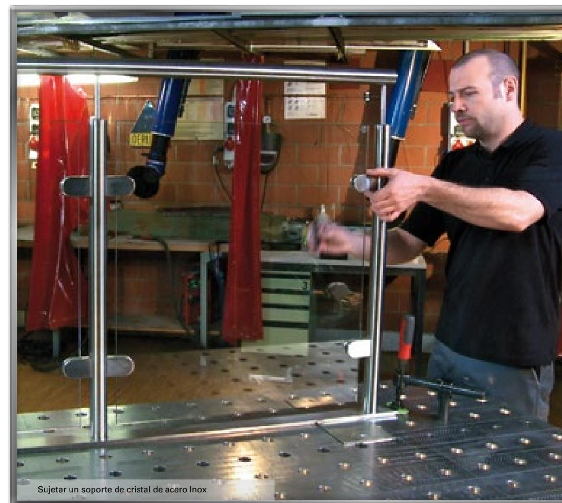
Sujetar un soporte de cristal de acero Inox
