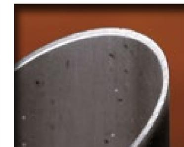
Desbarbar completamente por fuera y dentro un tubo seccionado
