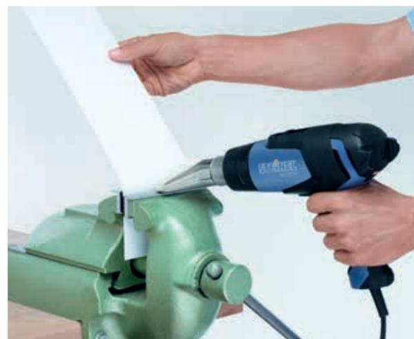
**Termoformar.** Darle forma al plástico a base de calor.
