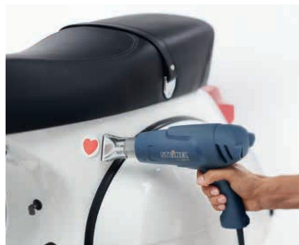
**Eliminar.** Con el aire caliente se pueden retirar fácilmente las pegatinas.
