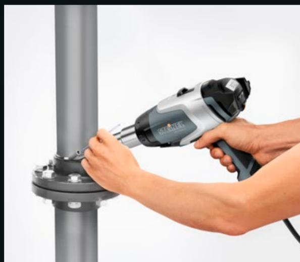
Termosoldado de plástico en la construcción de depósitos y aparatos.
