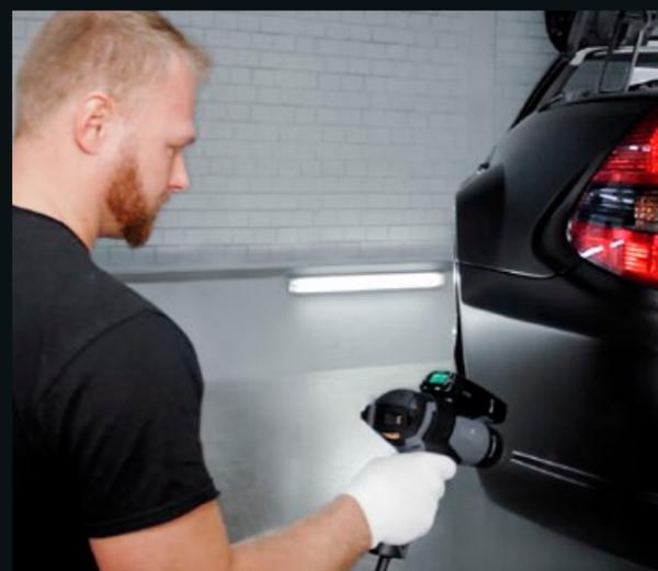
Aire caliente y registro de temperatura con una mano para laminar vehículos.
