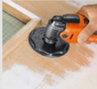
El disco abrasivo grande redondo reemplaza lijadoras adicionales como lijadoras excéntricas o lijadoras roto orbitales.
