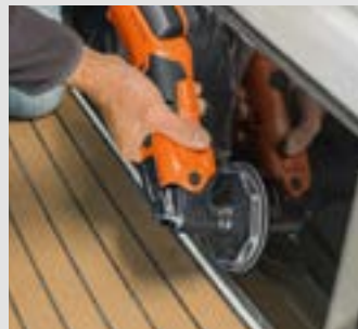
Hojas de lija con recubrimiento de material celular para eliminar rayaduras, p. ej. acrílicas y de policarbonato.
