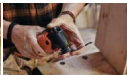
... solo tiene que posicionar el accesorio en el alojamiento Starlock y encajarlo mediante un clic. Listo.
