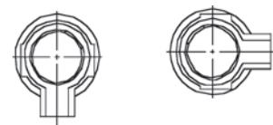
La particular geometría interna permite la aplicación horizontal o vertical.
